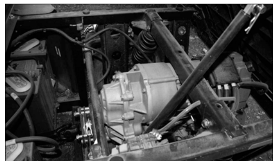
Le cœur de l'engin : fini le carbu et les cylindres, place au générateur électrique, fiable et silencieux. (DR)
