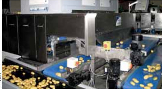
Le trieur optique permet d'améliorer la régularité du tri, la productivité mais également les conditions de travail.
