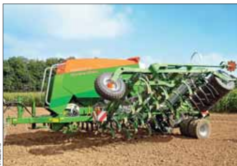
Le semoir Cayena dispose d'un grand dégagement entre les trois rangées de dents, facilitant le passage dans les résidus.
