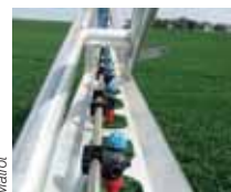
La nouvelle rampe se démarque par une partie inférieure réalisée en une seule pièce, grâce à un profilé extrudé.
