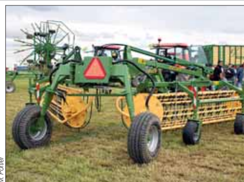
Landaineur Elho V-Twin 750 combine deux éléments de râteau faneur à entraînement hydraulique.
