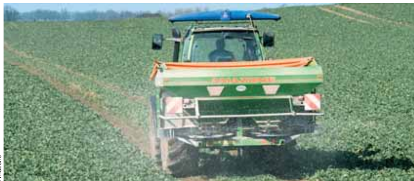
Permettant de valider la dose épandue instantanément, la pesée embarquée correspond au débitmètre du pulvérisateur.
