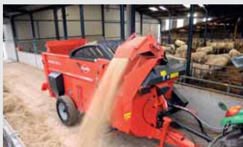
Sur les désileuses-pailleuses, certaines pièces d'usure comme les couteaux et le contre couteau sont à surveiller : la qualité de découpe en dépend.
