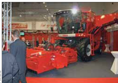
L'intégrale Quatro dispose d'une puissance de 410 chevaux et d'une capacité de trémie de 12 à 13 tonnes.
