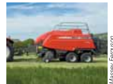
La presse à balle cubique MF 2140 réalise des balles de 80 X 70 centimètres.
