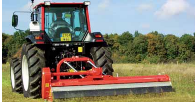
Pour plus de polyvalence, certains broyeur à axe horizontal sont déportables sur le côté.
