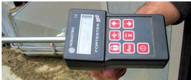
Pour les éleveurs pratiquant le séchage en grange, le testeur d'humidité permet d'arrêter le séchage une fois le taux de matières sèches atteint, afin d'éviter les consommations d'énergie inutiles.
