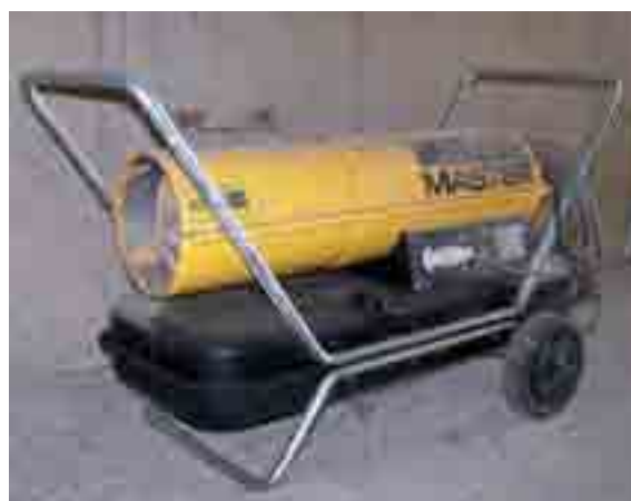
Photo 6 : pour un coût d'achat de l'ordre de 1200 € HT , le canon à air chaud permet d'améliorer les conditions de démarrage des veaux en hiver avec une consommation d'énergie limitée (3,5 kWh/veau)
