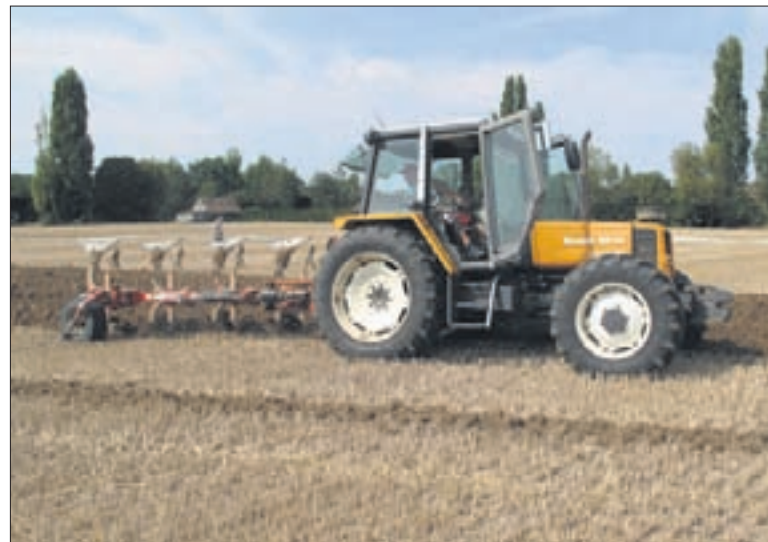
En travaillant à 300 ou 400 tr/min en dessous du régime maximal, une économie de 1,5 à 2 l/h de carburant pour un labour est possible.
